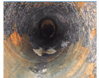
**Imagen Izquierda:** Estruvita bloqueando la tubería de 30 cm de diámetro. Limpiador mecánico cada 3 - 4 meses antes de **Magnetizer®**.
